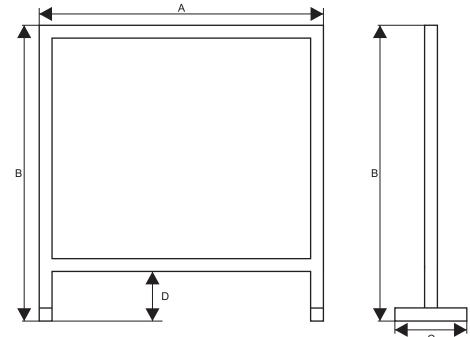
Přepážky z námi nabízené rozměrové řady jsou opatřeny nožičkami z profilu 30x30, které zajišťují stabilitu při položení např. na pult. Díky tomu, že přepážka není ukotvena nepevně, umožňuje v případě potřeby snadnou manipulaci.
